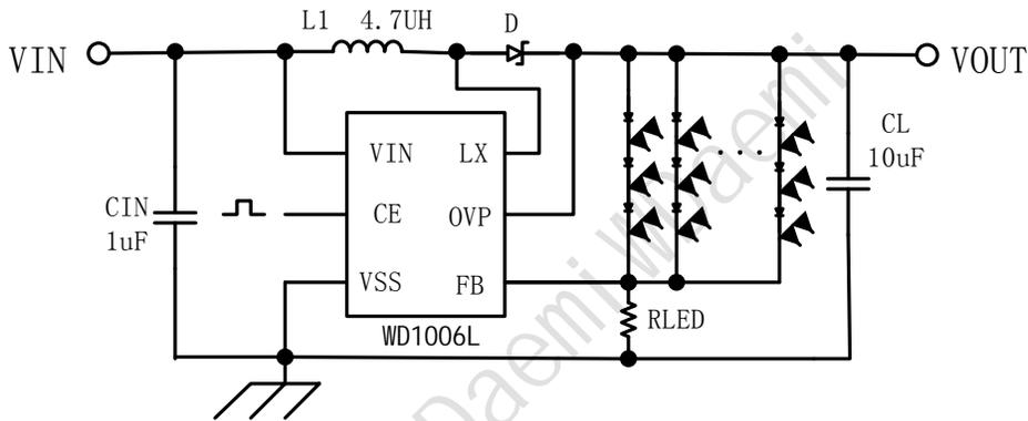
注:电路中  $R_{LED} = V_{FB} / (I_{LED} * n)$ ， $V_{FB}$  为 FB 端输出电压， $n$  为 LED 并联的路数， $I_{LED}$  为流过每一路 LED 灯的电流。CL 必须使用 10uF 以上电容；
